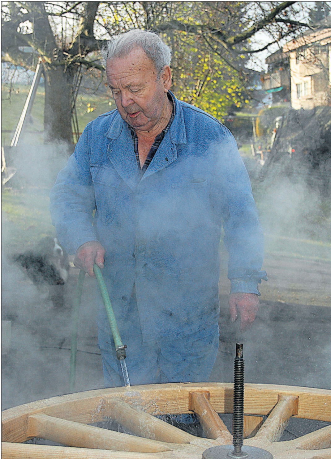
Ein frisch aufgezogenes Holzrad mit Wasser kühlen: Wagner Heinrich «Heiri» Lang, 83 Jahre alt, bei seiner Arbeit. Ein Handwerk, das langsam verloren geht. (Bilder Urs Oskar Keller)
