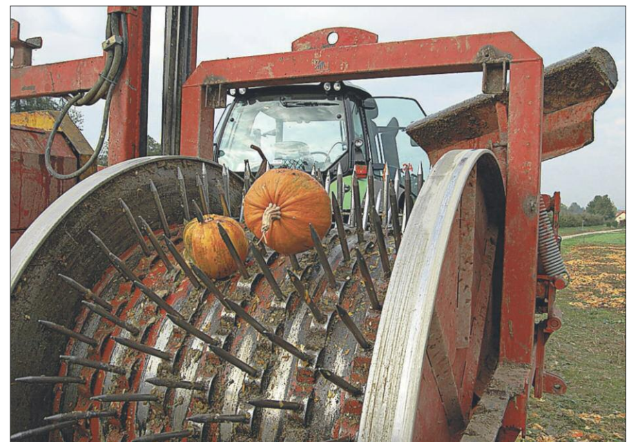
Der so genannte «Igel» der Erntemaschine sammelt die Kürbisse ein, danach werden in einer Trommel die Kerne vom Fruchtfleisch getrennt.
